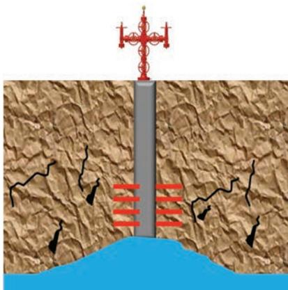
**Figura 17.** Conificación.
