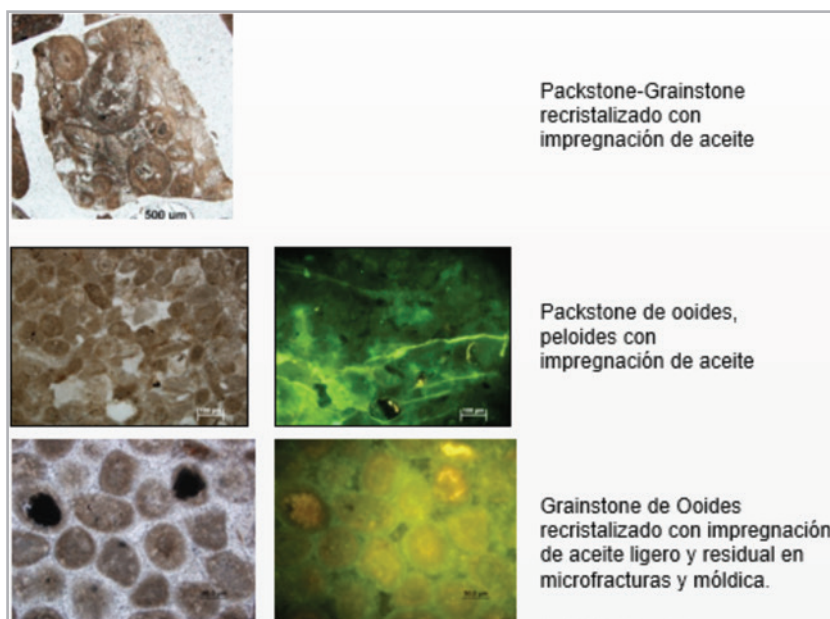
Figura 2. Láminas delgadas obtenidas de los núcleos de pared.
