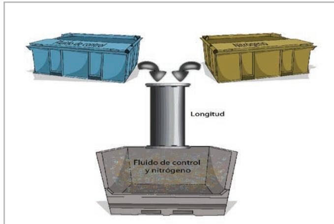
**Figura 8.** Inyección del fluido de control y gas nitrógeno a través de la tubería de perforación.
