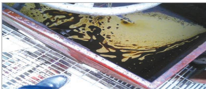
**Figura 7.** Fluido de control y aporte de hidrocarburos de la formación.
