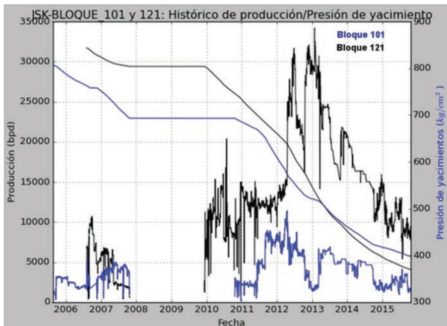
**Figura 10.** El comportamiento de presión de fondo en los pozos productores ha mostrado que el yacimiento está dividido en dos bloques que se llaman 101 y 121. El bloque 101 contiene tres pozos: Kab-38, 43 y 101. El bloque 121 contiene seis pozos: Kab-33, 63, 81, 103B, 106 y 121.
