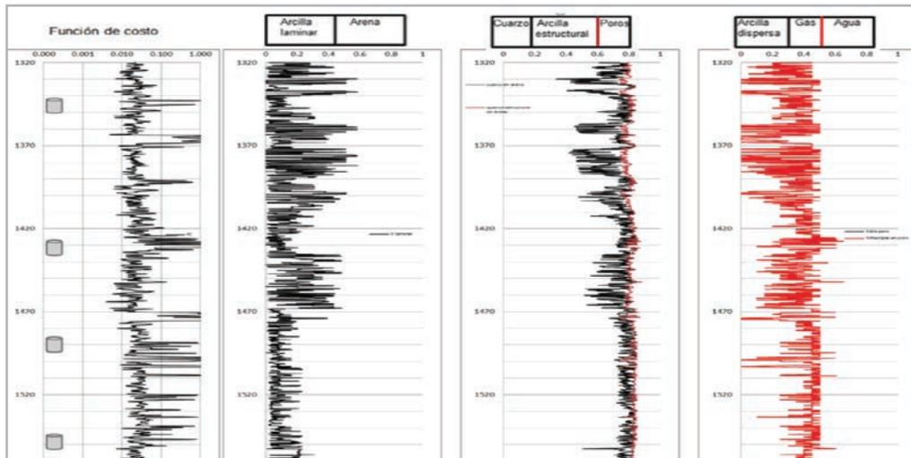
**Figura 11.** La función de costo (FC) actúa como parámetro de control de calidad y discretización de los tres tipos de arcilla; Vclam, Vcest y Vcdis, incluyendo a la porosidad y fluidos.
