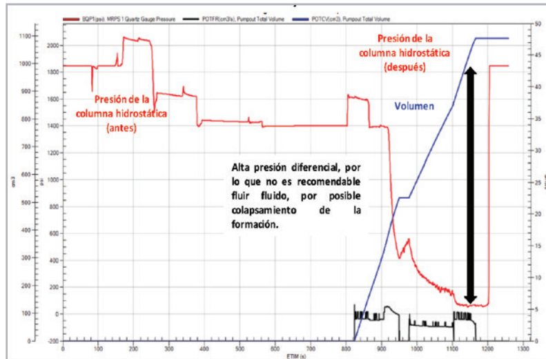
Figura 8. Gráfica característica, de un intento fallido para realizar una prueba de flujo.
