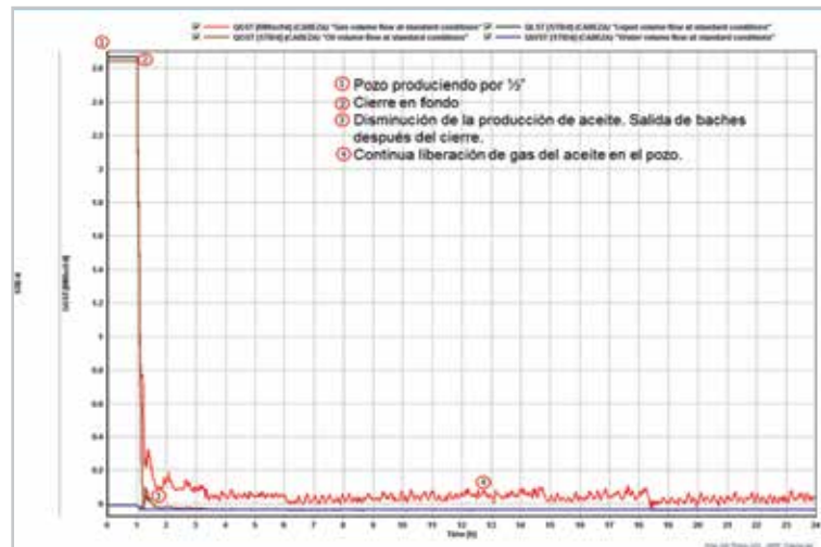
Figura 8. Cierre en fondo y liberación de fluidos por baja presión
