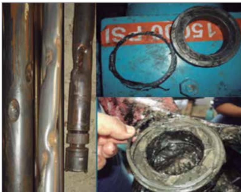
**Figura 5.** Fallas de las herramientas del aparejo DST-TCP.
