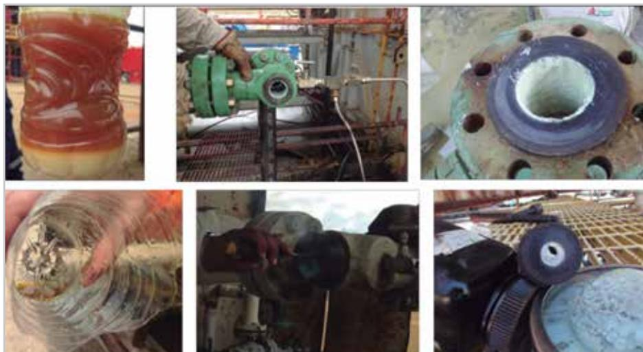
**Figura 5.** Evidencia de incrustaciones de sal en pozos del bloque I de Teotleco.
