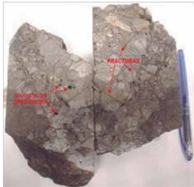
Figura 2. Rocas dolomitizadas con gran presencia de fracturamiento-disolución de la formación Cretácico, donde se determina CAA y CGA.
