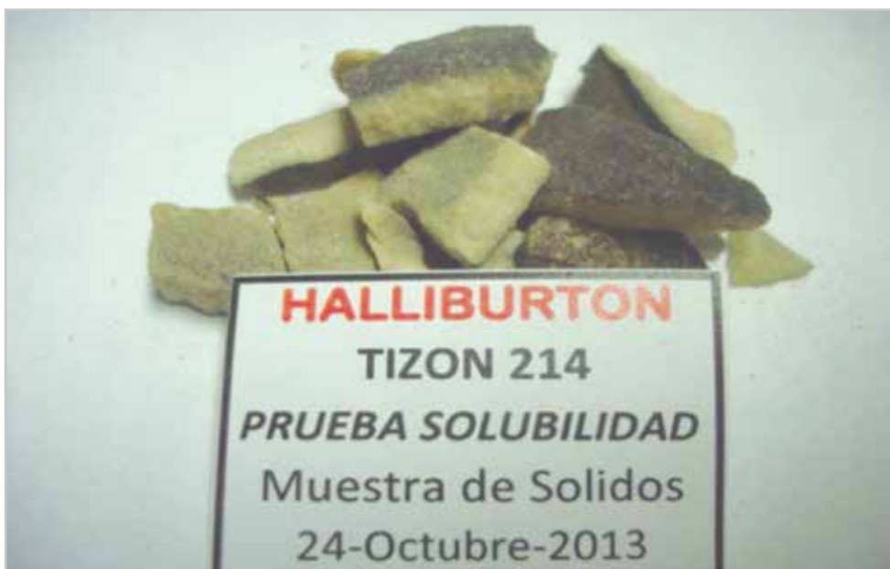
Figura 6. Incrustaciones de carbonato de calcio del pozo Tizón 214.
