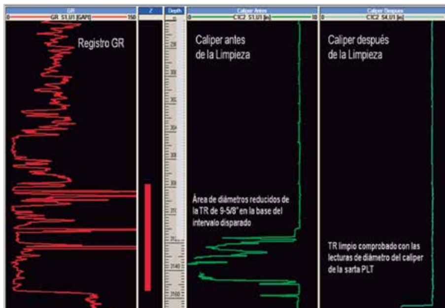
Figura 6. Comparación de calibre antes y después de la limpieza del pozo en el caso 1.
