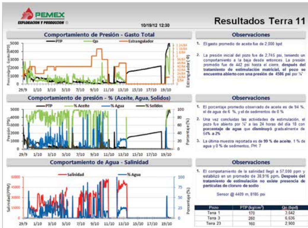
Figura 8. Gráfica de comportamiento de presión durante trabajos de estimulación de limpia y matricial.
