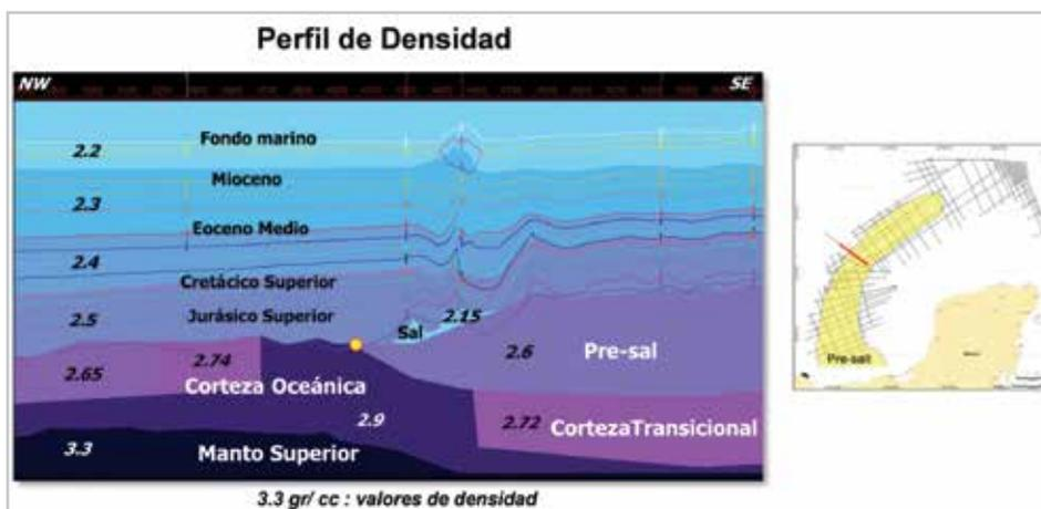
**Figura 3.** En el perfil de densidad se muestran los valores asignados a las diferentes rocas de la columna sedimentaria, de la corteza y del manto superior.
