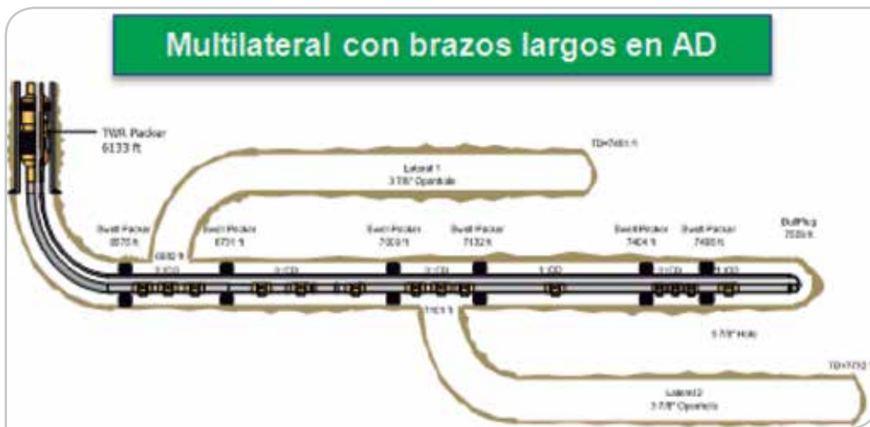
Figura 21. Esquema de pozo multilateral de dos brazos en la brecha del KS en agujero descubierto.
