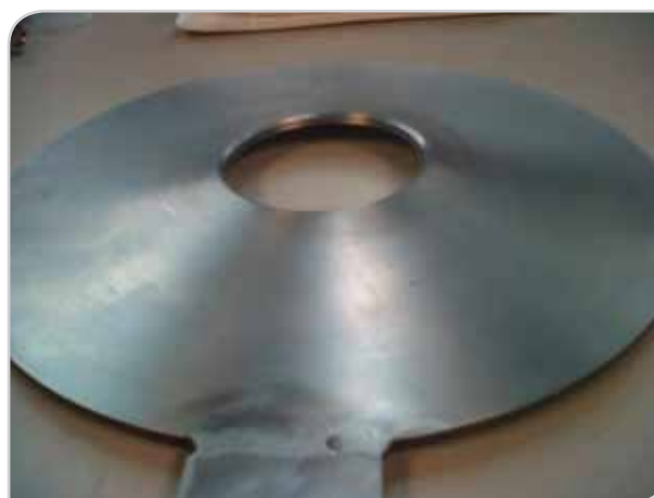
Figura 8. Placa deflectada o pandeada.
