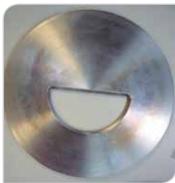
Figura 17. Placa con obstrucción al 50%.
