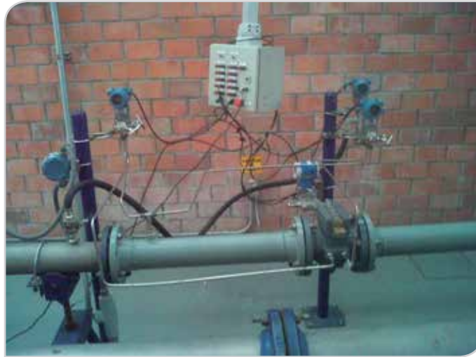
Figura 4. Arreglo de dispositivo portaplaca de 4” en el laboratorio secundario de flujo de CIATEQ.
