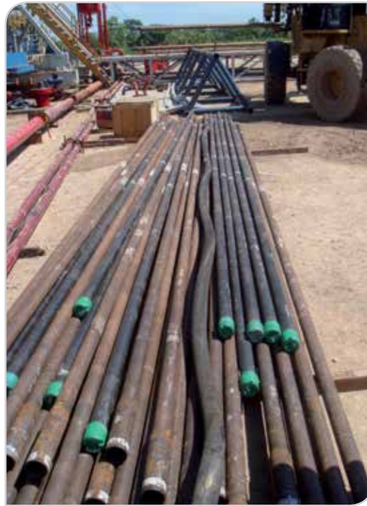
Figura 8. Barril de la bomba deformado en el pozo Samaria 916, después de la estimulación.
