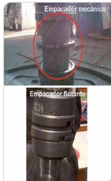
Figura 7. Empacadores utilizados en la prueba piloto.
