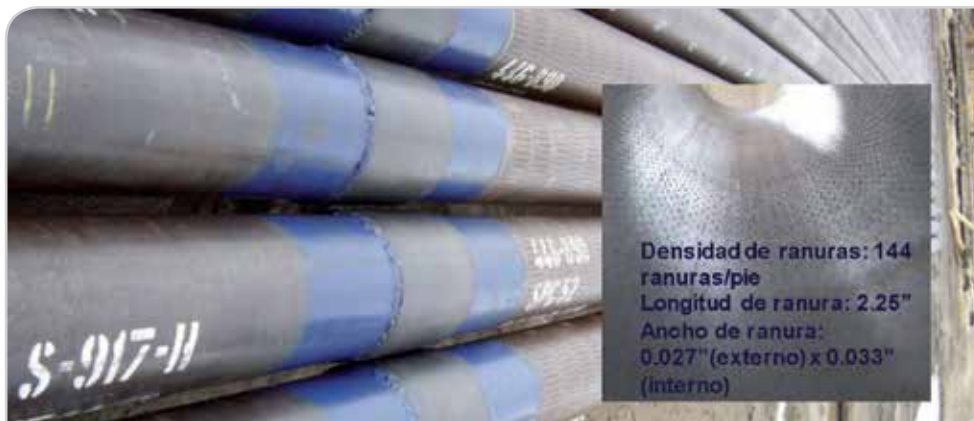
Figura 5. Tubería ranurada utilizada para el control de producción de arena.
