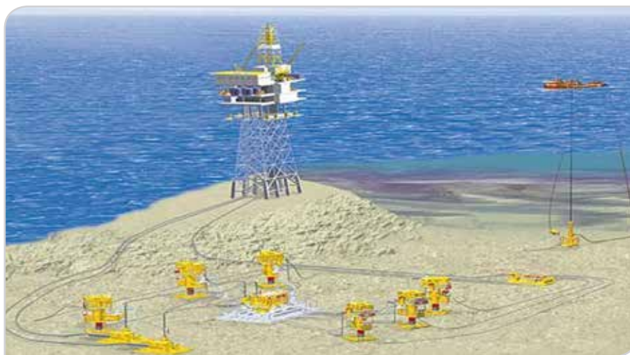
Figura 1. Sistema submarino de producción conectado vía tie back a una plataforma fija.
