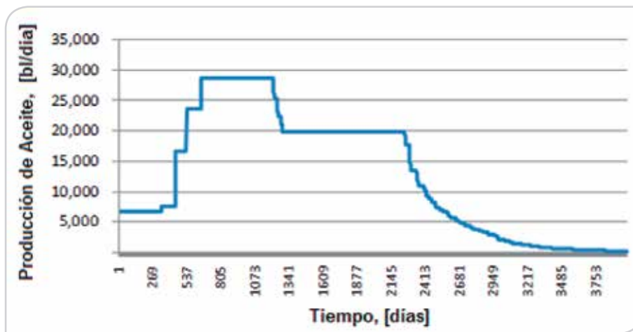
Figura 10. Perfil de producción de aceite para la opción de producción por bombeo neumático auto abastecido, (BNAAC).
