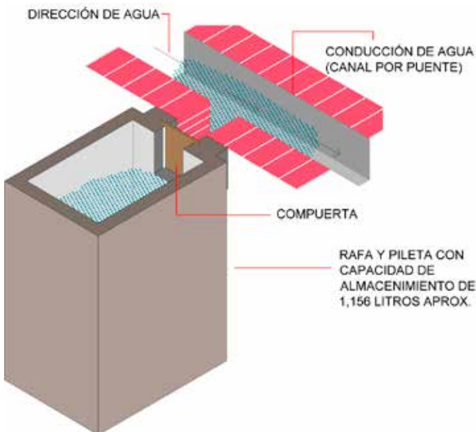
Figura 10. Isométrico de la pila adosada al puente. Nótese el funcionamiento para el almacenamiento de la pila.
