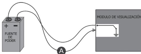
El circuito utilizado para cuantificar el consumo energético del modulo de visualización se enseña en la figura 16 donde básicamente se adiciona un amperímetro conectado en serie entre la fuente de poder y el modulo de visualización. Los resultados obtenidos se enseñan a continuación (tabla 1).
