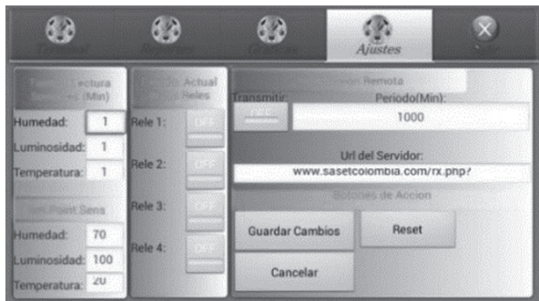
FIGURA 11. Interfaz de Usuario del Sistema (Modulo de conexión Bluetooth).
