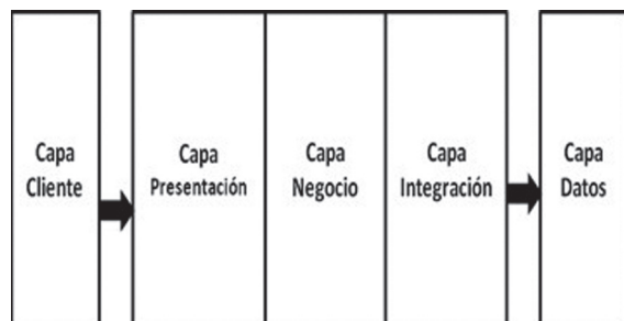
FIGURA 2. Capas típicas de una arquitectura multicapas.
