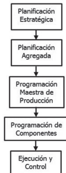
FIGURA 1. Jerarquía del Proceso de Planificación, Programación y Control de la Producción desde la teoría clásica.
