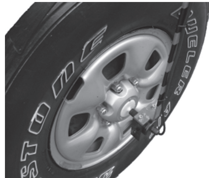
FIGURA 9. Montaje del codificador en la llanta de la camioneta
