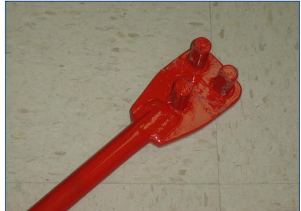
Fig. 3. Cabezal del maneral.
