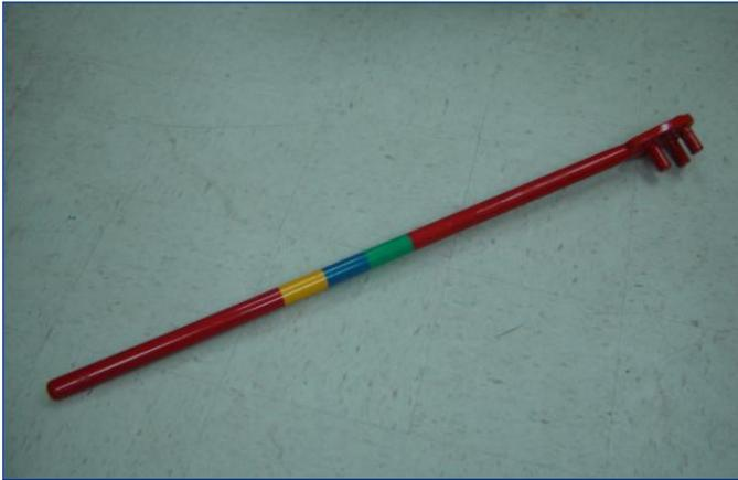
Fig. 2. Maneral operador de válvulas.
