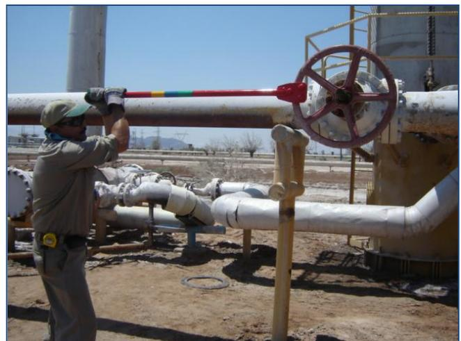
Fig. 4. Utilización del maneral para cerrar una válvula maestra del pozo (izquierda) y para abrir una válvula de agua separada (derecha).
