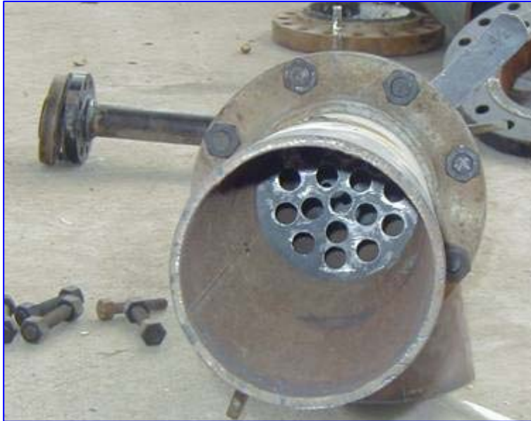
Fig. 7. Prototipo del silenciador propuesto.
