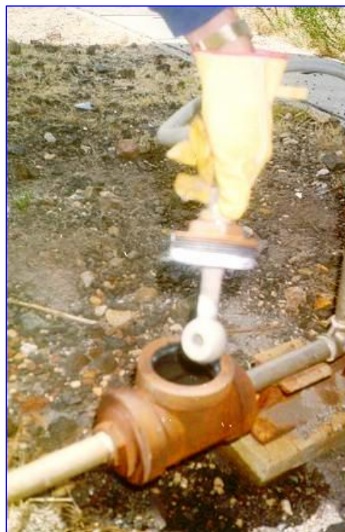
Fig. 2. Sensor de conductividad eléctrica tipo toroide, fabricado en teflón
