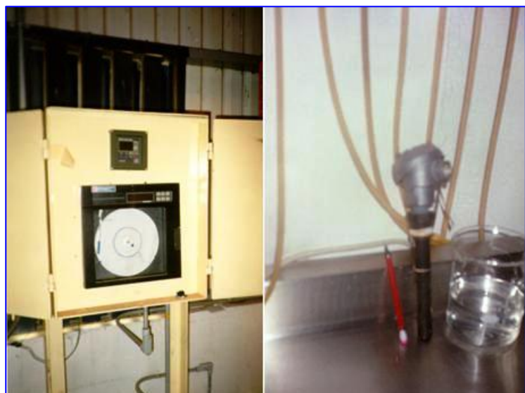
Fig. 1. Equipo de medición de conductividad eléctrica A la izquierda, analizador y registrador, y a la derecha celda de conductividad fabricada en grafito.
