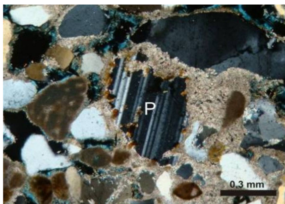
FIGURA 7. Detalhe de grão de plagioclásio (P) parcialmente substituído por cimento carbonático. Amostra 13, PX.
