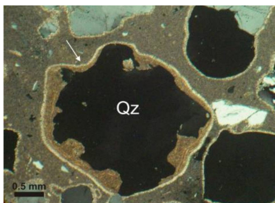
FIGURA 14. Grão de quartzo monocristalino (Qz) incrustado por alga vermelha envolvida por franja de cristais prismáticos (seta). Amostra submersa A, PX.
