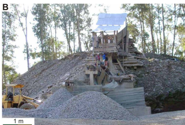
FIGURA 7. Pedreira do Basalto da Serra Gaúcha, Município de Nova Prata, RS: A) laje para calçamento de ruas, o produto principal; B) brita para agregados, aproveitamento de resíduos rochosos.
