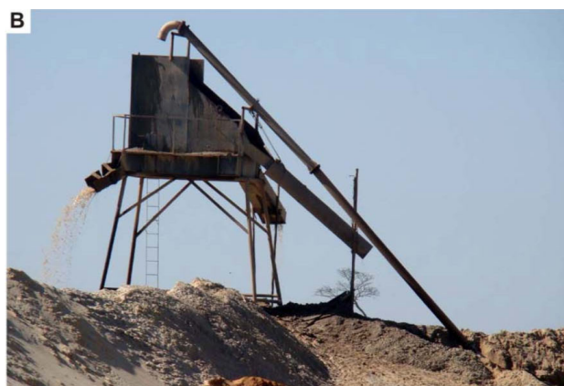
FIGURA 5. Extração de areia natural a partir do depósito quaternário no Município de Barra de São João, RJ: A) jazida de areia natural; B) lavagem da areia extraída.
