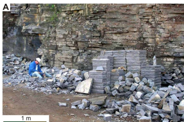
FIGURA 7. Pedreira do Basalto da Serra Gaúcha, Município de Nova Prata, RS: A) laje para calçamento de ruas, o produto principal; B) brita para agregados, aproveitamento de resíduos rochosos.
