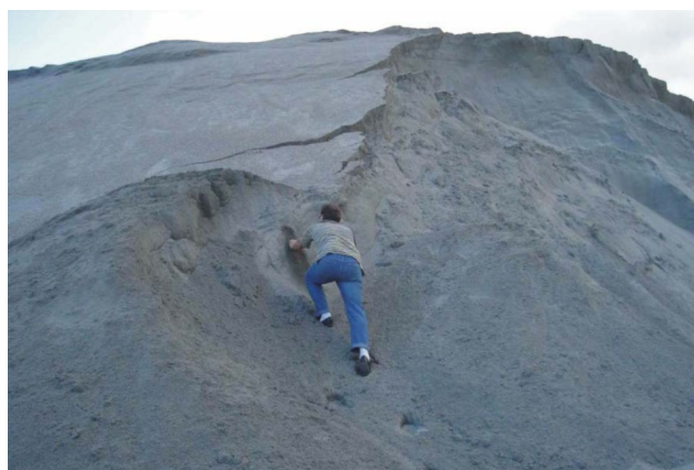
FIGURA 6. Fração fina de fragmentos de rocha, um subproduto de fabricação de brita, Seropédica, RJ.
