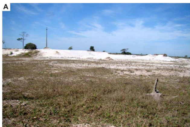
FIGURA 5. Extração de areia natural a partir do depósito quaternário no Município de Barra de São João, RJ: A) jazida de areia natural; B) lavagem da areia extraída.
