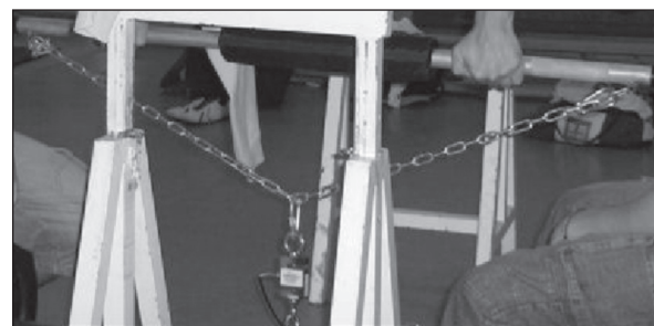
Figura 2 - Colocação da corrente na célula de carga.
