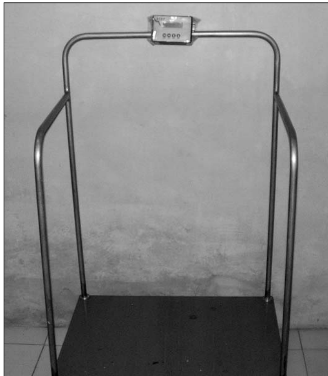
Figura 2 – Banco eletrônico, anteparo e microprocessador.
