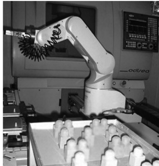
Figura 14. Brazo robótico realizando proceso de ensamble de mesas y sillas
