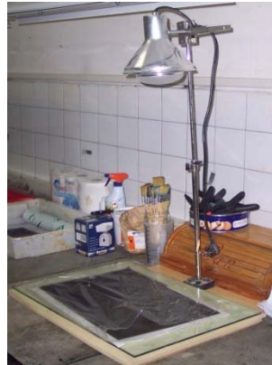
Fig 11 (insoladora artesanal diseñada por Norberto González)
