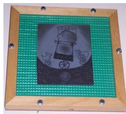
Fig. 7( Marco de vacío con plancha laminada y fotolito)
