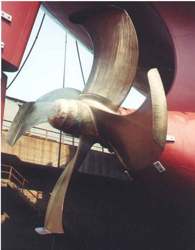
Figura 1. Hélice CLT instalada en el bulkcarrier “Paiute”
