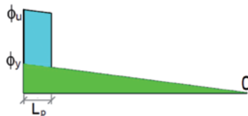
Fig. 5: Distribución idealizada de curvatura de la viga (Park & Paulay, 1976)
