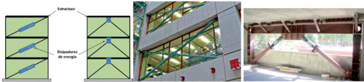
Fig. 1: Sistemas de control pasivo. ( www.bcee.concordia.ca/index.php/Pall's_friction_dampers , Edificio de estacionamiento, Kent/WA)
