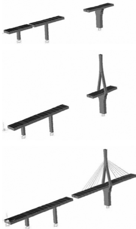
Fig. 16. Ejemplo de las fases constructivas consideradas.
