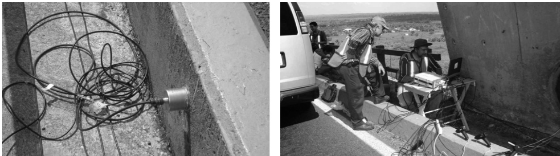
Fig. 9. Acelerógrafo en posición y central de adquisición durante las pruebas dinámicas.
