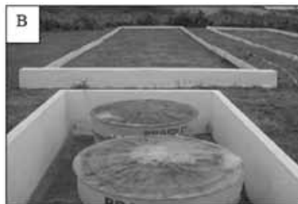
FIGURA 4 - Parcelas de erosão na Bacia Experimental de São João do Cariri: (A) Vista da Parcela 1 (solo exposto) e (B) Detalhes dos tanques para coleta de dados
