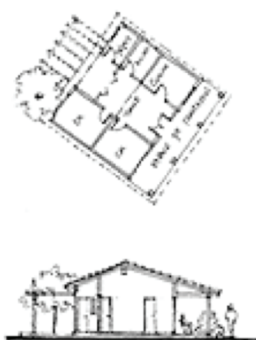
Imagen 4. Tipologías ubicadas en el sector: Tipo culata yovai. Esquemas en planta y vista.
