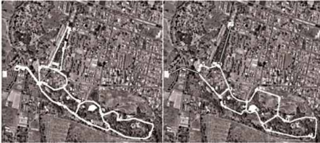
Figura 2. Alternativas inicial e intermedia de diseño de rutas, ramales y ubicación de estaciones cuya eficiencia fue evaluada a través de simulación por medio del software PRTsim. Fuente: elaboración propia.
