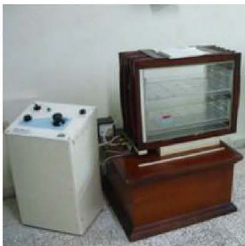
Figura 2. Estimulador electromagnético regional (BIONAK-3) con distribución espacial predeterminada de campos magnéticos en el tiempo, utilizado en la aplicación de los campos electromagnéticos.
