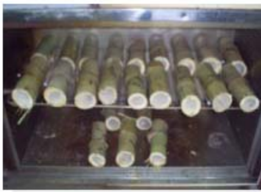
Figura 3. Deseccación de culmos de Bambusa vulgaris var. vulgaris para la determinación de masa seca.
