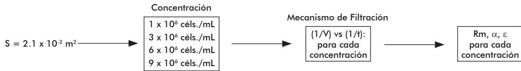
Figura 5. Dirección lógica de la simulación de la capacidad del flujo de perfusión ( F_p ) y el tiempo de filtración del spinfilter durante el cultivo, en función de la densidad celular ( X(t) ), el tiempo ( t ), el área de filtración ( S ) y la velocidad de giro del spinfilter ( n ).
