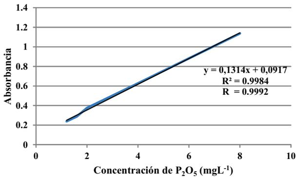
**Figura 1.** Curva de calibración para cuantificación de P en forma de  $P_2O_5$
