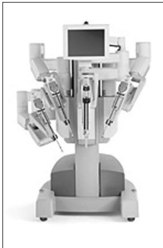
Modelo de nueva generación lanzado al mercado en 2006. Cuenta con 4 brazos, cada uno con altura ajustable y capacidad de rotación; además, se despliegan y posicionan a demanda del cirujano para su colocación adecuada, cada uno porta un instrumento. Asimismo, cuenta con una pantalla plana unida a un brazo articulado que permite que el ayudante del cirujano y la enfermera instrumentista tengan acceso visual a la imagen para que asistan durante el procedimiento.
