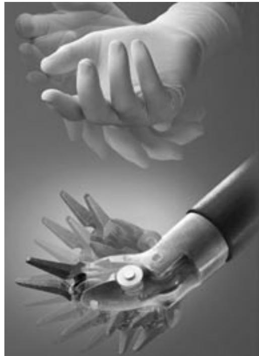
Gran versatilidad de los instrumentos robóticos con 6 grados de movimiento que se obtienen por sistemas de micro-poleas y cables. Amplia diversidad de instrumentos para todas las necesidades quirúrgicas.
