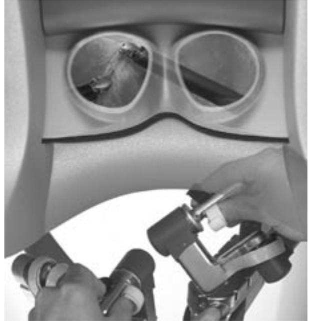
Telescopios con dos canales de visión, dos cámaras de 3 chips, y con disponibilidad de visión recta y angulada.
