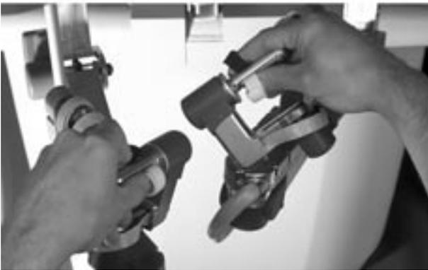
Control manual del cirujano que origina los movimientos que ejecuta el robot en la escala seleccionada.
