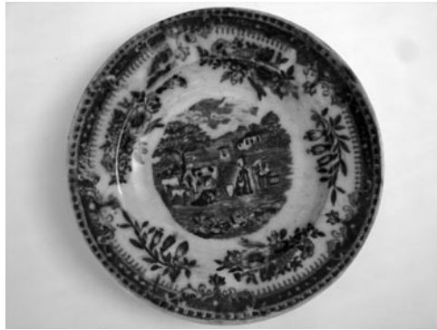
Figura 22: Plato de la Fábrica de Loza Bogotana con varios defectos perceptibles en los elementos decorativos, como el corte irregular del motivo central y el desfase en la unión de la franja del borde del plato.
