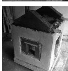
Figura 43: Fotografía ensayo a escala reducida. Casa de tapia reforzada con malla.
