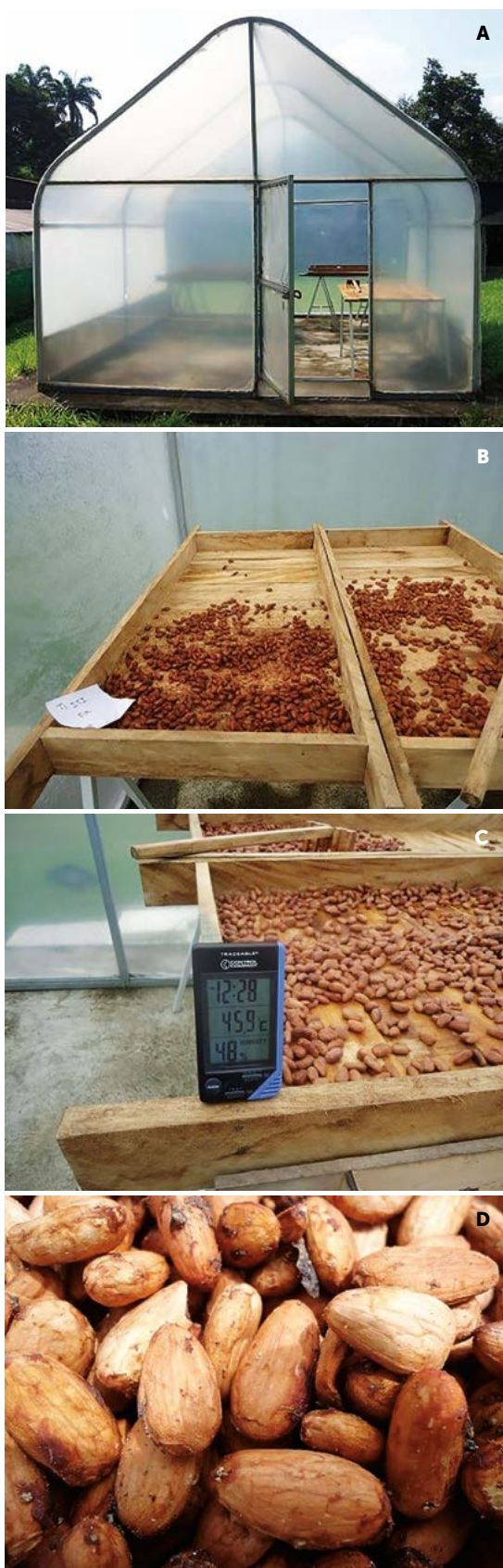
Figura 3. A: Secador solar tipo invernadero. B: Secado de almendras de cacao ( Theobroma cacao L.) en cajones de madera. C: Control de humedad relativa y temperatura en el interior del secador. D: Almendras de cacao al final del secado.
