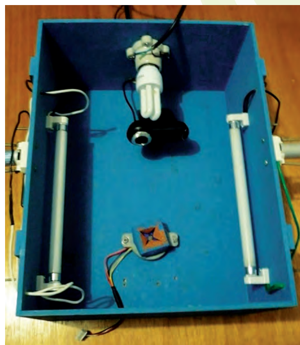
Figura 3. Sistema de parametrización morfométrica del fruto de lima Persa ( Citrus latifolia Tanaka), para obtener una adquisición de imágenes desde 360°.
